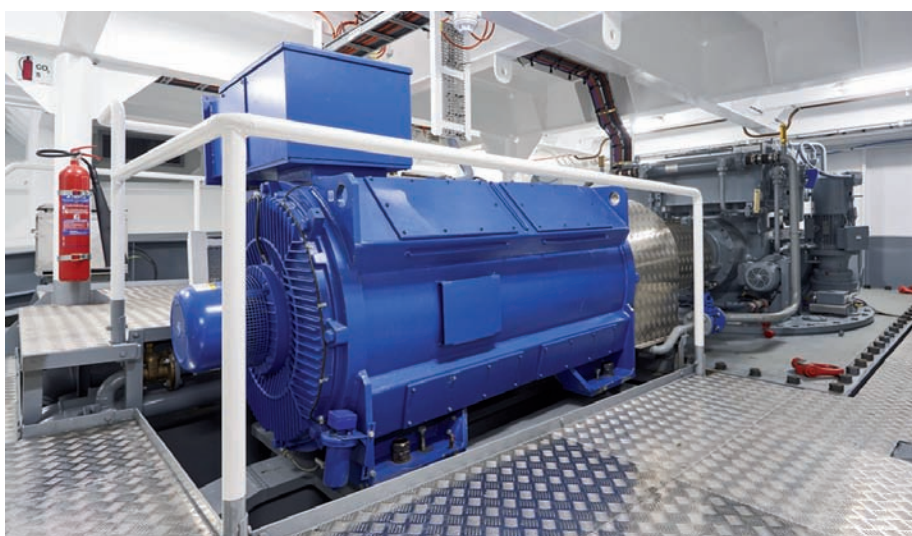
> Motor eléctrico Marelli para accionar una de las hélices azimutales.
