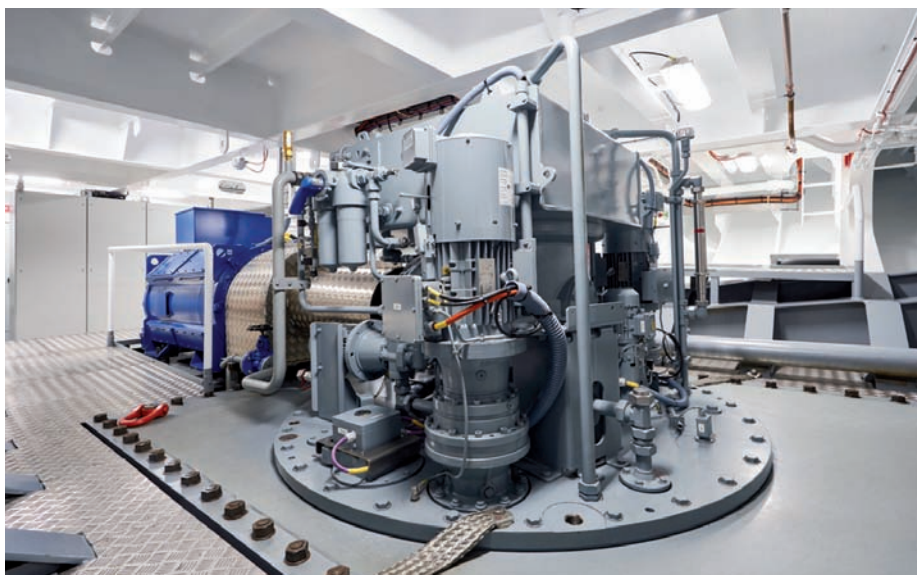
➤ Sección en el interior del casco de una de las propulsoras azimutales de Schottel.
