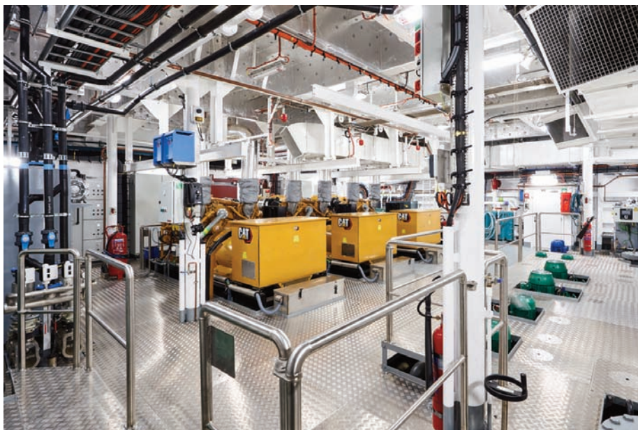
> Sala de máquinas con los tres generadores principales del buque.
